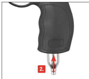
2. CO 2 -Kapsel wie abgebildet einlegen.
